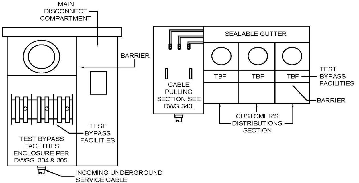
**FIG. 2** TYPICAL SERVICE TERMINATION ENCLOSURE COMBINATION METER SOCKET PANEL COMMERCIAL USE.
